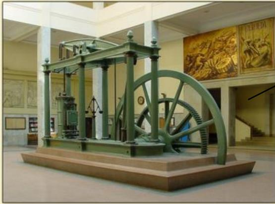
Une chaudière à charbon chauffe de l'eau et la transforme en vapeur. Cette vapeur arrive dans un cylindre et tantôt pousse, tantôt tire un piston. Ce piston actionne une bielle qui fait tourner une roue. Cette roue transmet le mouvement aux machines associées car elle est reliée à celles-ci par des courroies...
